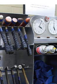
自動車板金の選手にとって何より大事なハンマー。20種類ものハンマーを使い分けて、さまざまな形をつくりあげる。
